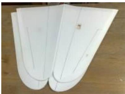
Тут всё как всегда : накладываю фаски на внутренние стороны обшивок, попарно склеиваю их скотчем по передней кромке, прокатываю на трубке лобки обшивок для формирования правильного профиля и приклеиваю стенки лонжеронов
