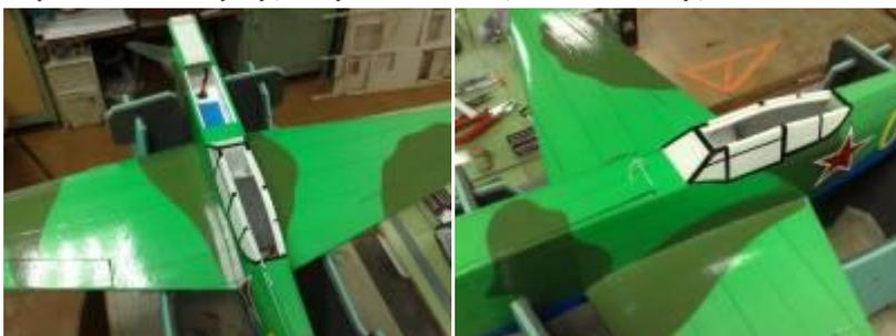
В общем-то это удобнее в эксплуатации и ни сколько не сложнее в изготовлении. Взлётный вес в итоге получился 522 гр. - совсем немного перебрал, но это обусловлено тем, что я поставил чуть более мощный моторчик, чем планировал изначально. Такой же двигатель стоит у меня на МикроАнгеле, а он заметно больше по размерам и весу, чем этот аэроплан.
