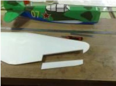
Навеску элерона традиционно сделаю за верхнюю обшивку, соответственно затачиваю переднюю кромку элерона:
